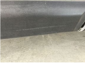
Kapı, sağ ön Kapı bandı > Çizik
