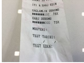
Elektrik donanımı/Pano Akü > Test Sonucu
