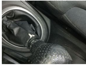
Şanzıman Vites körüđü > hasarlı
