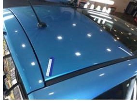
Tavan Tavan > Dolu hasarı
