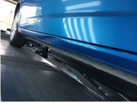
Marşbiyel, sağ Marşbiyel, sağ > hasarlı
