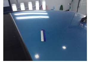
Tavan Tavan > Dolu hasarı
