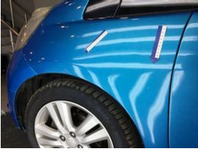
Çamurluk, sol Çamurluk, sol > Boyası atmış
