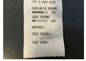
Elektrik donanımı/Pano Akü > Test Sonucu
