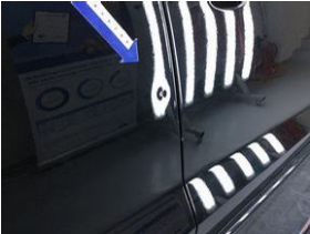
Kapı, sağ arka Kapı, sağ arka > Ezik
