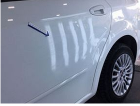
Kapı, sol arka Kapı, sol arka > hasarlı
