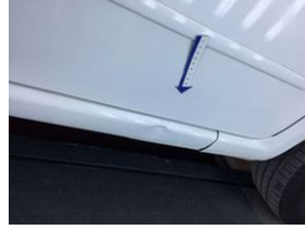
Marşbiyel, sağ Marşbiyel, sağ > hasarlı
