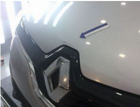
Motor kaputu Motor kaputu > hasarlı
