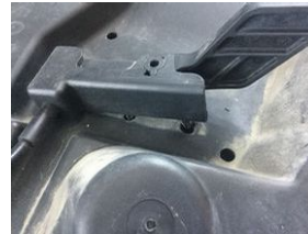
Motor kaputu Kilit mekanizması > Sabitlemesi hatalı
