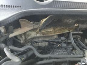
Motor kaputu İzolasyon döşemesi > hasarlı
