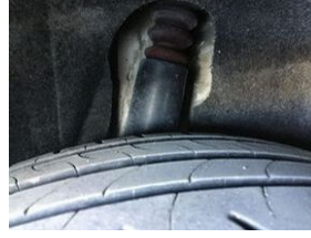
Arka aks Amortisör körüğü, sağ > hasarlı
