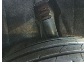
Arka aks Amortisör körüğü, sol > hasarlı
