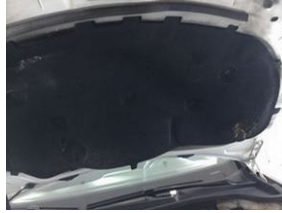
Motor kaputu İzolasyon döşemesi > hasarlı
