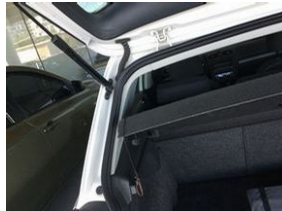
Döşemeler/Kapaklar Pandizot > hasarlı
