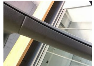
Döşemeler/Kapaklar A-direk iç kaplaması, sağ > Yakıcı madde ile zarar görmüş
