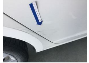
Kapı, sağ arka Kapı, sağ arka > Yüzeysel çizik
