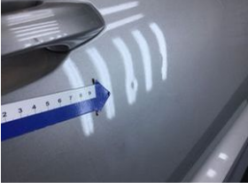
Kapı, sağ ön Kapı, sağ ön > Noktasal ezik
