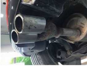
Egzoz sistemi Arka boru > Standart dışı onarım
