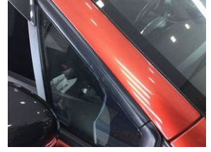
Kapı, sağ ön Cam sıyrıcı fitili, dış > hasarlı
