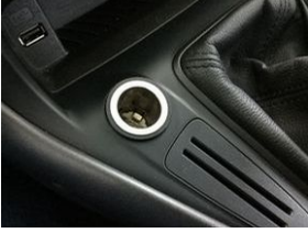
Elektrik donanımı/Pano Çakmak > sökülmüş/yok
